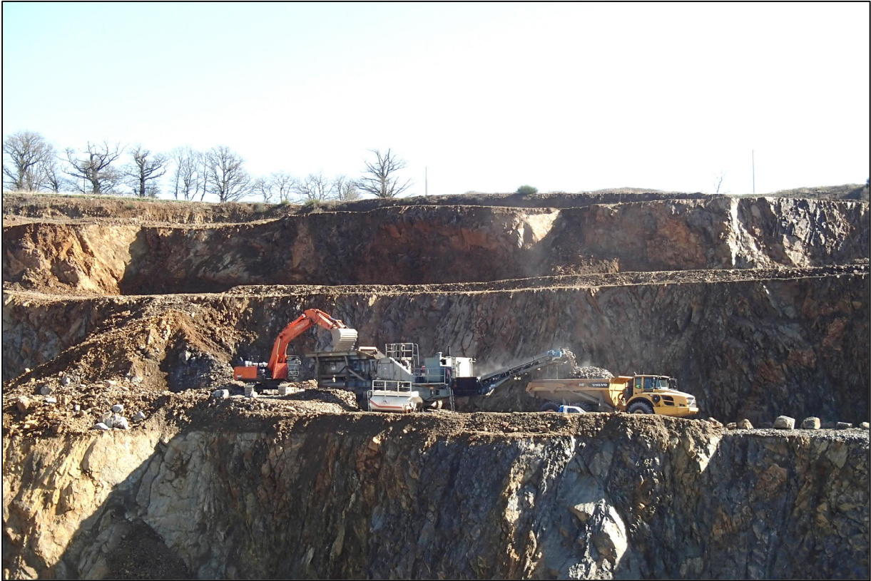
Figure 14 - Opération de reprise du matériau en pied de front pour alimentation du concasseur primaire et chargement direct du tombereau
