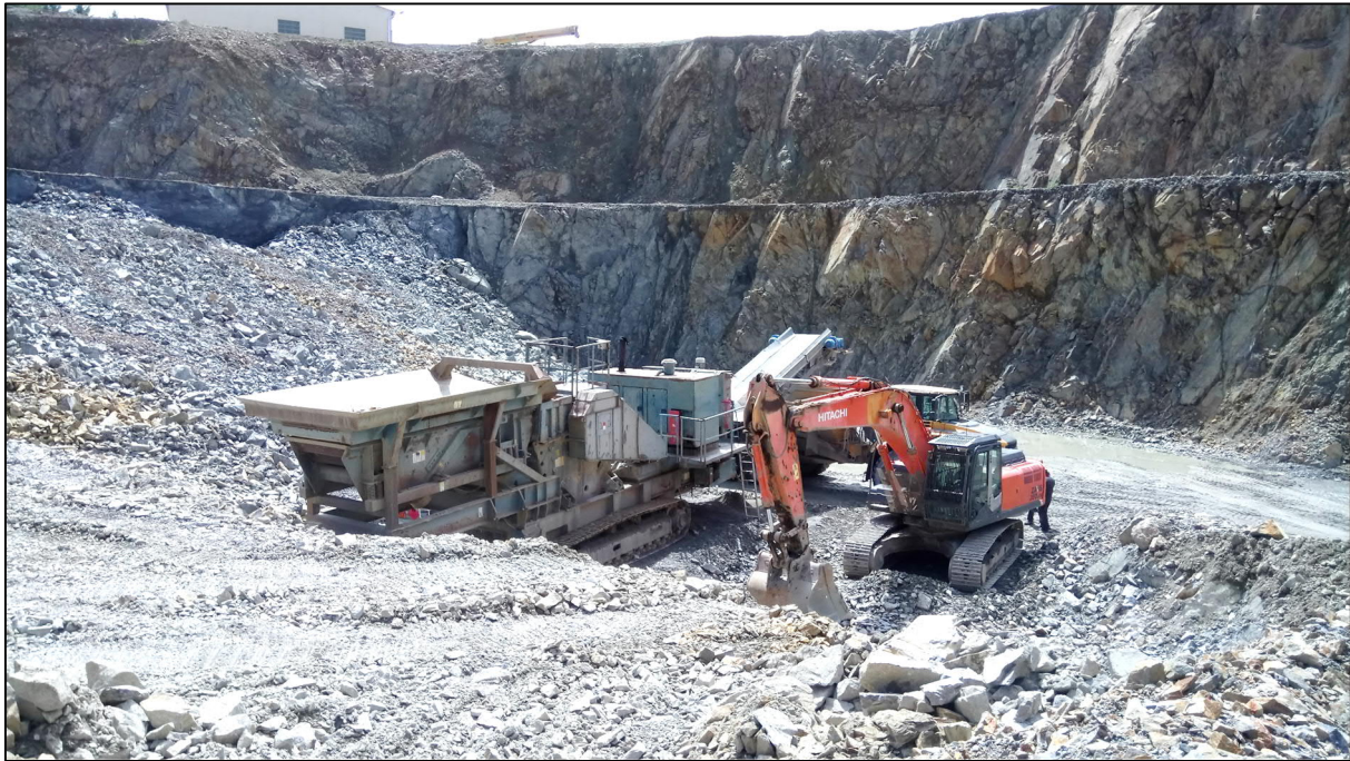
Figure 23 - Concasseur mobile primaire alimenté par la pelle
