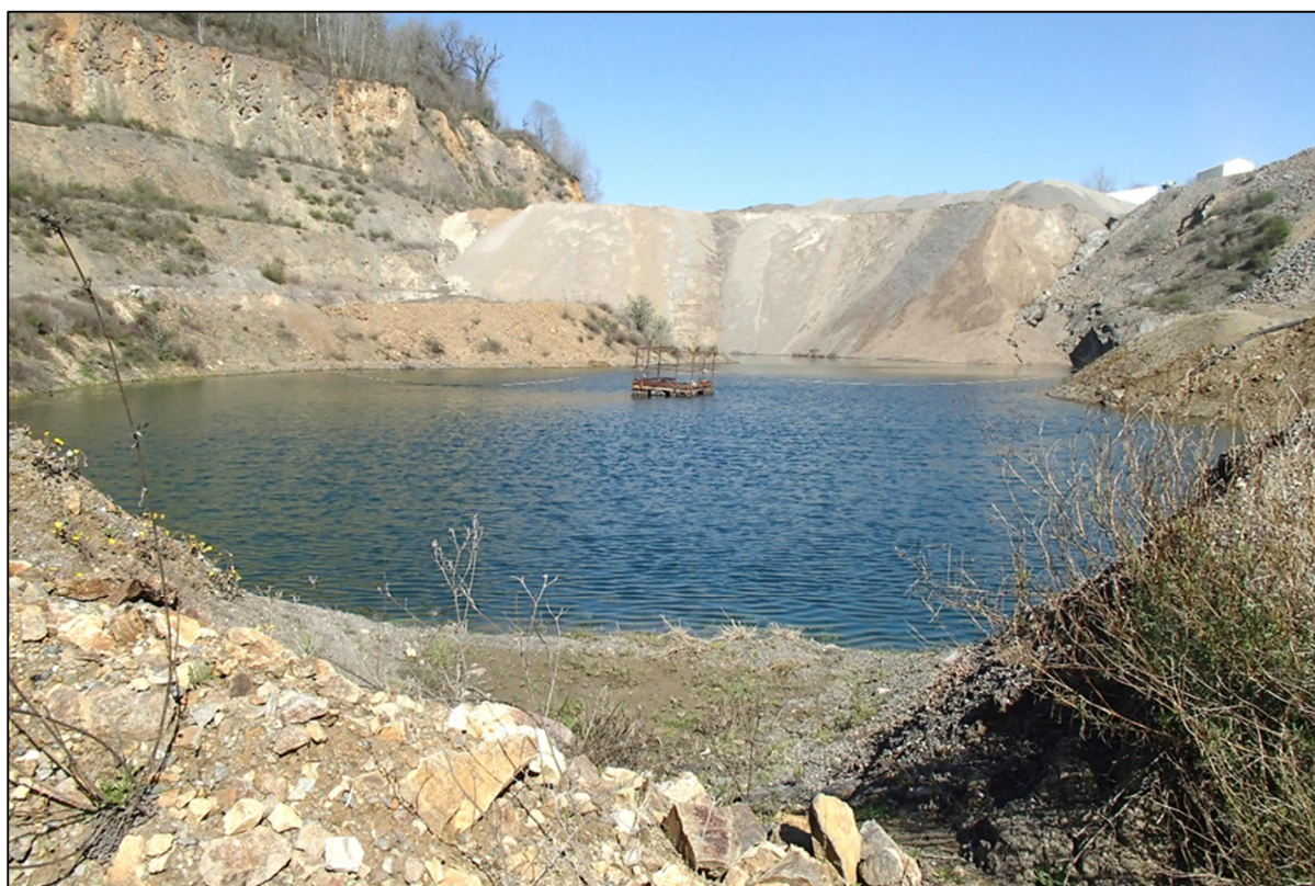
Figure 18 - Bassin de pompage en fond d'excavation dans la fosse de Saint-Martin-le-Mault
